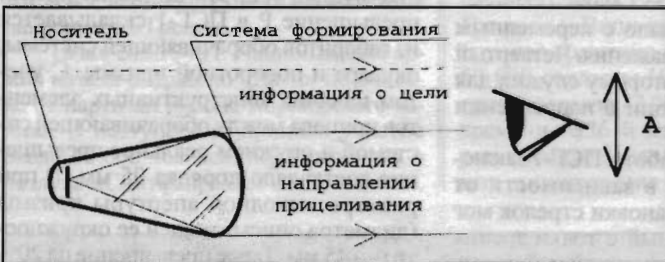
Рис. 3. Оптическая схема прицела серии GS. Вся оптическая часть такого прицела представляет только один светодiode со специальной асферической фронтальной поверхностью! Физические ограничения на диаметр оптической части такого прицела — 2 мм. Легко представить, что с излучателем «GS» можно построить самые компактные дневно-ночные оптико-электронные прицелы.
